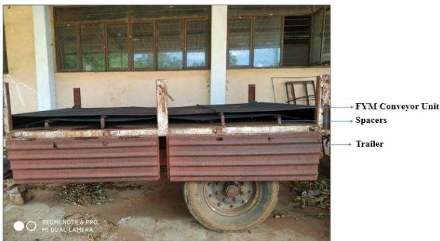
Fig. 3. FYM conveyor unit
